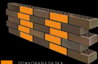
3 ЛОЖКОВАЯ КЛАДКА СМЕЩЕНИЕ НА 1/4 КИРПИЧА
