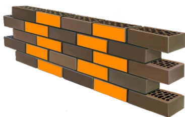
4 ЛОЖКОВАЯ КЛАДКА СМЕЩЕНИЕ НА 1/4 КИРПИЧА
