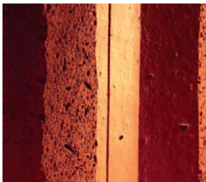
Рис. 6. Поризованная структура черепка
