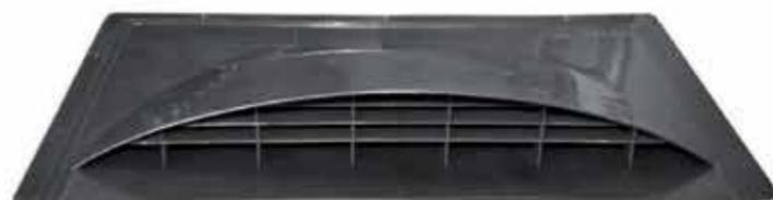
**АЭРАТОР пластиковый „СПЕЦИАЛЬНЫЙ“** предназначен для вентиляции подкровельного пространства. Один аэратор обеспечивает вентиляцию 25 м<sup>2</sup> кровли. Температура эксплуатации от -70 °С до + 110°С. Имеет площадь выпуска воздуха 132 см<sup>2</sup> и устанавливается из расчета 4-5 штук на 100 м<sup>2</sup> кровли при условии, что высота подкровельного вентилируемого пространства равна 5 см.
