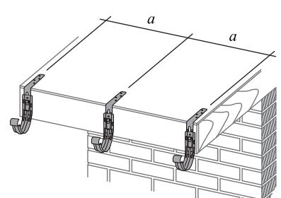
При использовании удлинителя крюка появляется возможность регулировки уклона желоба до 50 мм (для обеспечения движения воды в желобе в сторону водосточного стояка).
