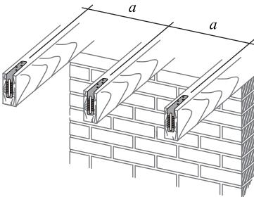
Установка коротких крюков выполняется на лобовую доску либо на торцевую плоскость стропил по аналогии с установкой длинных крюков.
