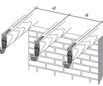
**Крюки универсальные** устанавливаются по аналогии со стандартными крюками крепления желоба и могут быть использованы как в качестве коротких крюков, так и в качестве длинных (при условии применения удлинителя крюка).
