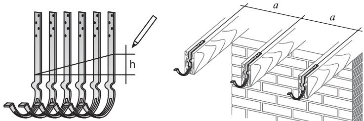
Крепление крюков осуществляется с помощью саморезов. При установке водостока из меди, обязательно применение саморезов из нержавеющей стали либо омедненных (анодированных) саморезов.
