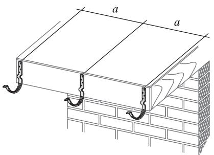
Выполняя загиб крюков, делайте поправку на угол наклона: передний край желоба должен быть на 6 мм ниже заднего.
