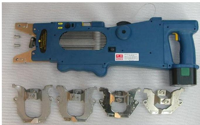
**Рис. 3. Общий вид автоматического пистолета для вязки арматуры**
